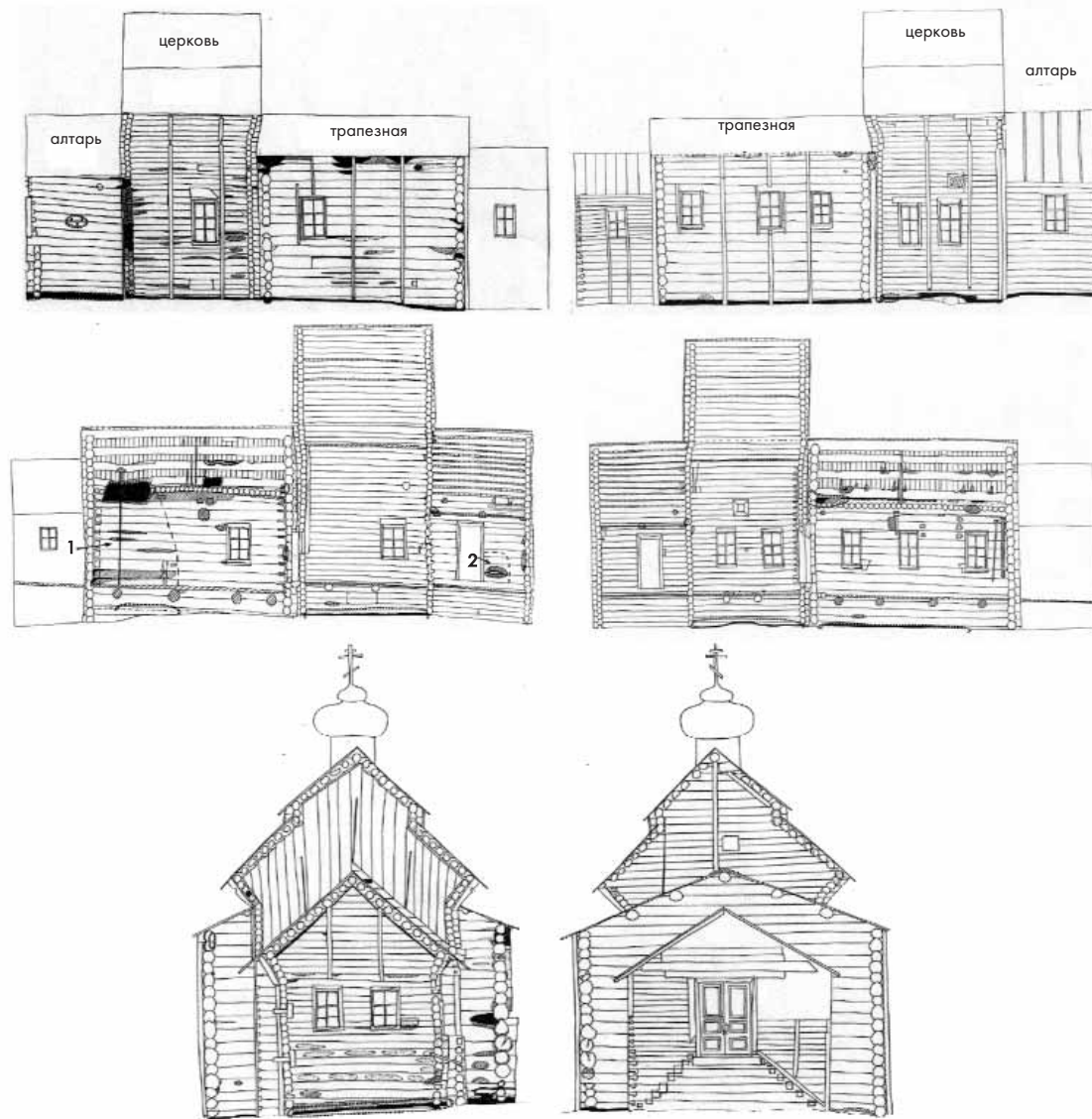
Рисунок 1. Схемы, показывающие очаги деструкции древесины на ковдской церкви. Зоны грибкового поражения затемнены, степень поражения соответствует степени затемнения.
